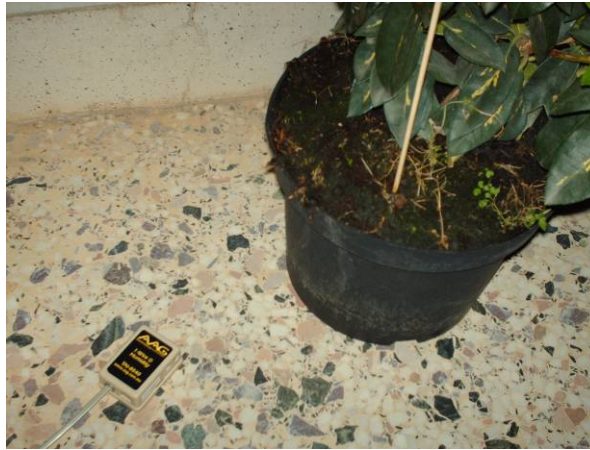
Εικόνα 30: Δίκτυο 1-Wire και συσκευή DS2438
