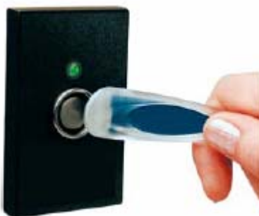
Εικόνα 4: επικοινωνία iButton με συσκευή βάσης
